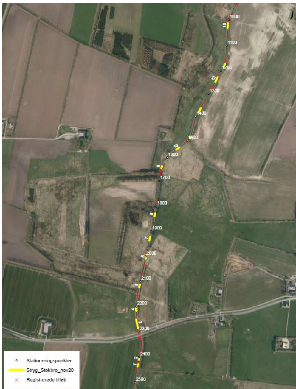
Skitse af Stokbro st. 2490 m til st. 1000 m, de 15 stryg er markeret med gult. Brinksikringen er ikke særskilt markeret, men ligger helt mod syd. Vejen nederst i flyfotoet er Bryndumvej.
